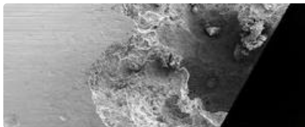
Corrosión por resquicios ( crevice )
