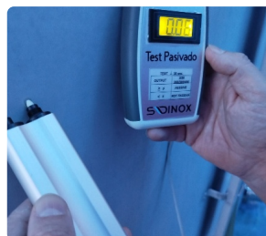
Test de pasivación por conductividad
